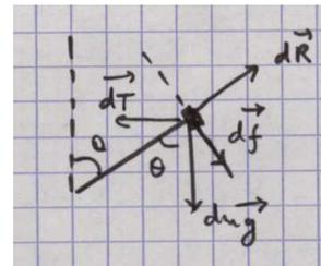
2) Lorsque l'on tient compte des forces de frottement, il faut prendre en compte la force  $d\vec{f}$  de la boule sur l'élastique. Voir figure ci-dessus. A la limite du glissement, on a:  $df = \mu dR$ . Le raisonnement est le même que pour la question 1) sauf qu'ici, on va projeter l'équation d'équilibre mécanique sur la normale à  $d\vec{R}$  puis sur  $d\vec{R}$  afin d'obtenir 2 équations et d'éliminer  $dR$ . On obtient:
