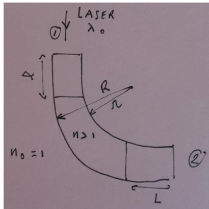
Déterminer les conditions sur  $R$ ,  $r$ ,  $L$  et  $l$  pour qu'on ait la même intensité en sortie (2) qu'en entrée (1).
