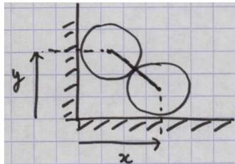
contact, le cylindre du dessus tombe avec l'accélération  $g$  pendant que celui du dessous n'est plus soumis à aucune force horizontale, donc il conserve sa vitesse. On doit trouver cette vitesse. Il y a deux équations que l'on peut écrire, en utilisant les notations de la figure: (1) la distance entre les axes des 2 cylindres est fixe jusqu'à la rupture du contact, (2) la conservation de l'énergie entre la position initiale (au repos) et l'instant de rupture du contact. Soit:
